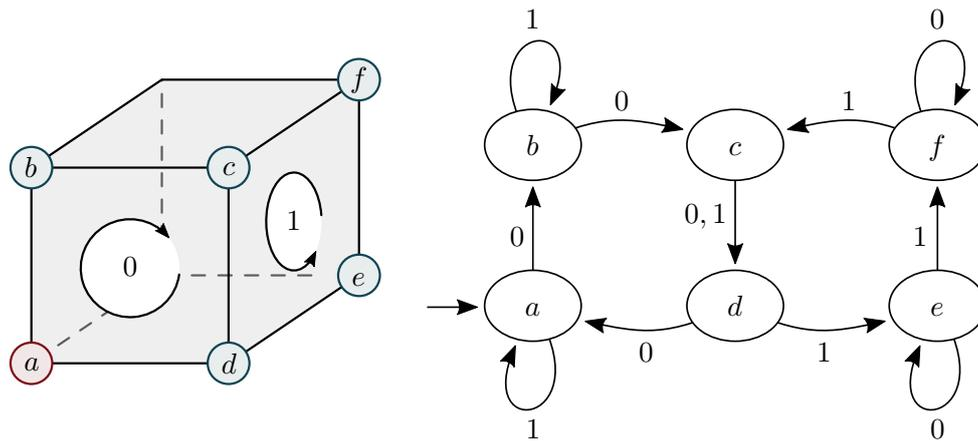
Wir betrachten nun, wie sich die untere linke Ecke eines Zauberwürfels verhält, wenn man die Sequenz ausführt, indem man bei einer 0 die Vorderseite im Uhrzeigersinn dreht, und bei einer 1 die rechte Seite gegen den Uhrzeigersinn. Dies ist links abgebildet. Rechts sehen Sie einen entsprechenden DFA.
