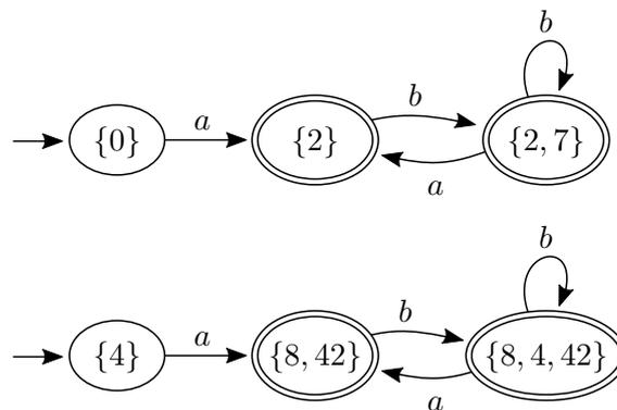
Nicht gezeichnete Kanten führen zu einem impliziten Fangzustand. Da beide DFAs identisch sind, müssen auch beide Teile des  $\epsilon$ -NFAs die gleiche Sprache akzeptieren. Somit können wir Zustände  $\{4, 8, 42\}$  löschen, und erhalten  $a(b|ba)^*$  als regulären Ausdruck äquivalent zu  $M$  mit Länge 6.
