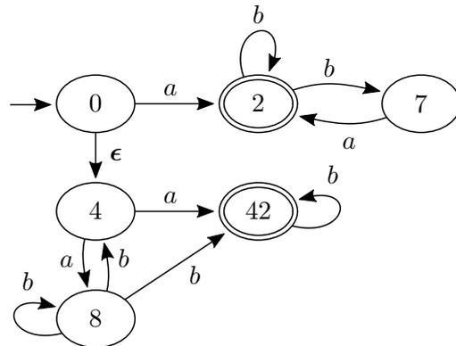
(b) Die oberen Zustände (also  $\{0, 2, 7\}$ ) des Automaten akzeptieren genau  $a(b|ba)^*$ . Dies sind die Wörter, die mit einem  $a$  beginnen und  $aa$  nicht enthalten. An dieser Stelle kann man auch durch clevere Umformungen darauf kommen, dass der untere Teil des Automaten genau die gleiche Sprache akzeptiert – falls man dies allerdings nicht bemerkt, bietet sich eine Potenzmengenkonstruktion an, um die beiden Teile zu vereinfachen.
