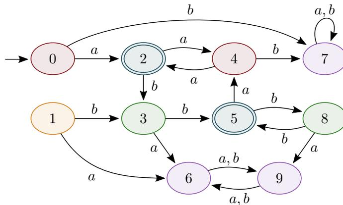
(b) Zuerst eliminieren wir den nicht-erreichbaren Zustand 1. Danach kollabieren wir äquivalente Zustände und erhalten folgenden Automaten.
