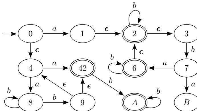
*Lösungsskizze.* (a) Zuerst entfernen wir die unnötigen Zustände 1, 3 und B.
