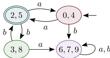
Zustand 7 ist ein Fangzustand, der DFA akzeptiert also die Sprache, die von dem regulären Ausdruck  $a(aa|bb)^*$  erzeugt wird.
